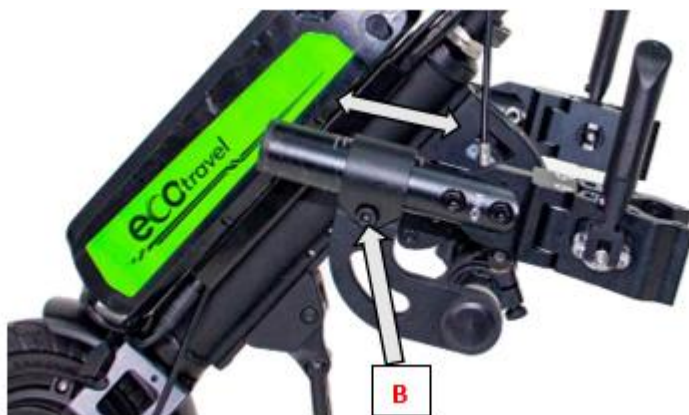
Obrázok 22. Nastavenie hĺbky upínacieho mechanizmu vzhľadom na zariadenie
