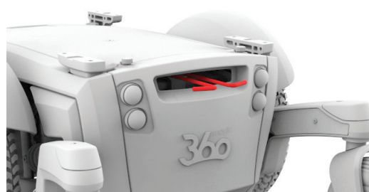
Obrázok 4.4b Brzdové páky Magic 360 uvoľnené
