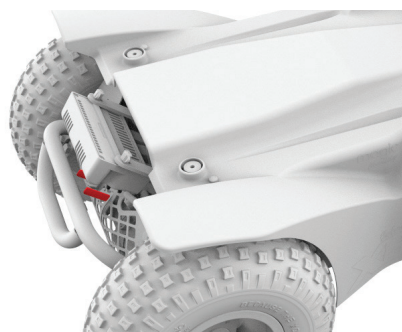
Obrázok 4.6a Brzdové páky Extreme X8 sú zapnuté
