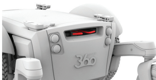
Obrázok 4.4a Brzdové páky Magic 360 zapnuté
