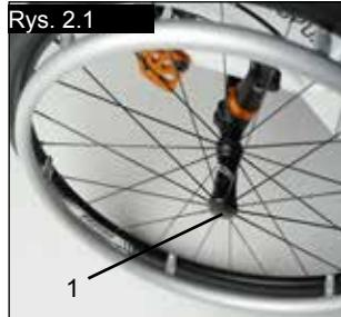
Podczas wsuwania pólusi do gniazda ramy w celu zamontowania tylnych kół utrzymywać przycisk pólusi wciśnięty. Aby zablokować koło we właściwej pozycji, zwolnić przycisk pólusi. Przycisk powinien powrócić do swojego pierwotnego położenia.
