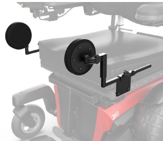
Obrázek 4.8a Chrániče kolen na středové opěrce nohou
